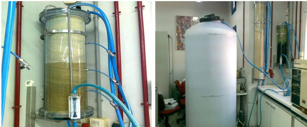
Εικόνα 4: Στήλη προσρόφησης ύψους 75cm γεμάτη πριονίδι τύπου 'spruce' ως προσροφητικό υλικό (αριστερά) και Βυτίο 1000L με διάλυμα Methylene Blue (δεξιά).
