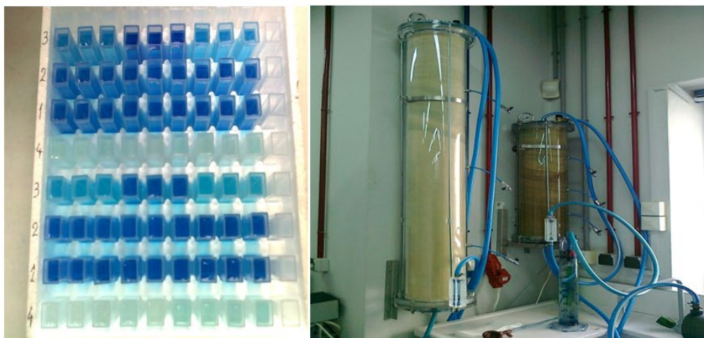
Εικόνα 6: Οι κυβέτες με τα δείγματα του εξερχόμενου υγρού (αριστερά), στήλες ύψους 150cm και 75cm γεμάτες πριονίδι είναι έτοιμες για την επανάληψη του πειράματος προκειμένου να ελαχιστοποιηθεί το στατιστικό σφάλμα.
